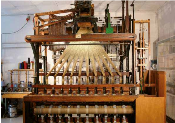
Das ist ein Jacquard-Bandstuhl aus dem Bandweberei-Museum, der bis 1998 in Betrieb war und fünf Farben weben kann. Das Stadtwapen von Hattingen wird derzeit gewebt. Foto: BHW
